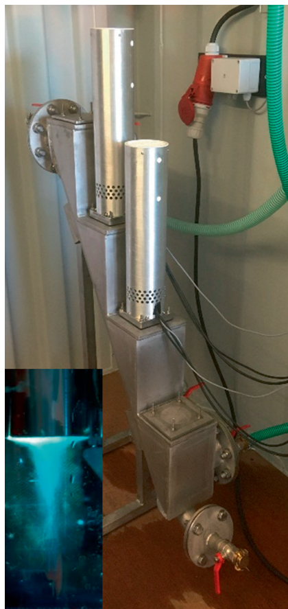
Abb. 2: Das stufenförmige Ultraschall-Modul koppelt mit bis zu vier Sonotroden Ultraschall in das durchströmende Wasser ein (hier nur zwei gezeigt). In den dabei ausgebildeten Kavitationszonen (kleines Foto) können Mikroorganismen desintegriert und chemische Verunreinigungen abgebaut werden (großes Foto: INP; kleines Foto: PRE).
