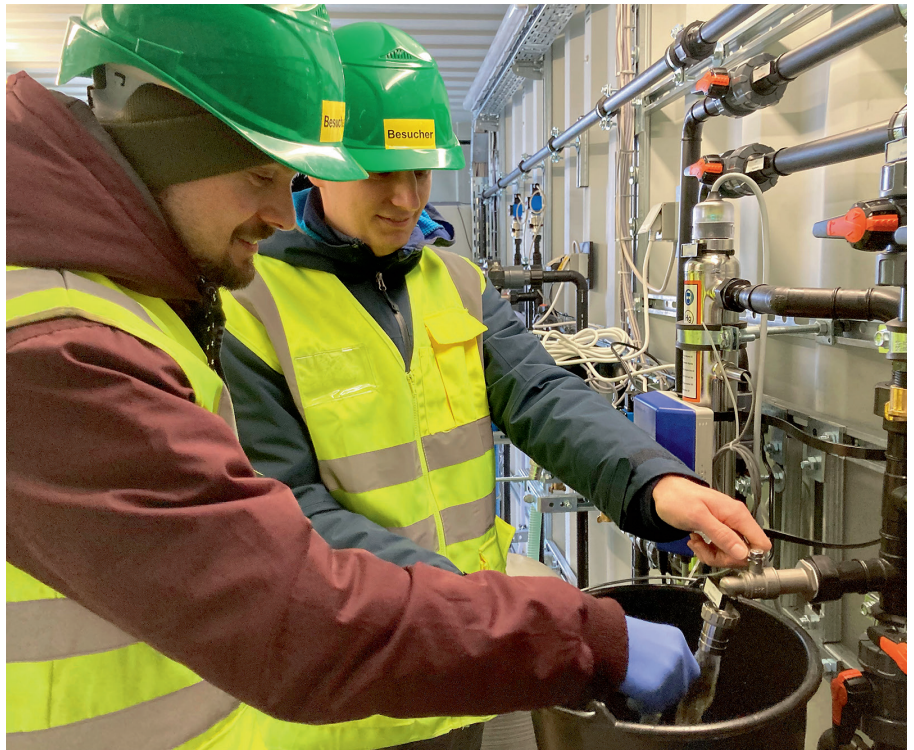
Abb. 4: Dr. Marcel Schneider und Raphael Rataj vom INP Greifswald entnehmen an einer der zahlreichen Probenahmestellen im Demonstrator Wasser, welches im Labor hinsichtlich der Keimbelastung untersucht wird (Foto: INP).
