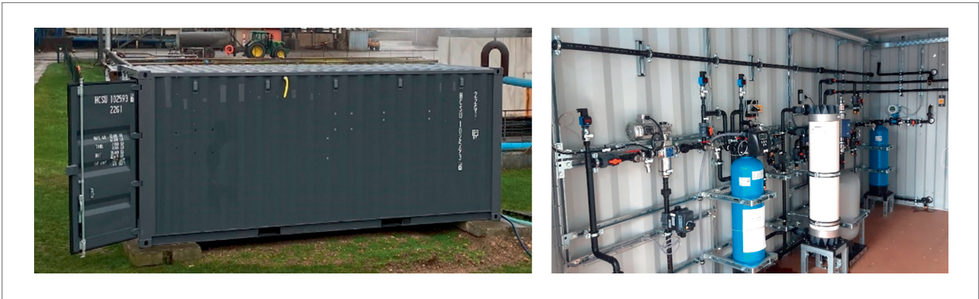
Abb. 1: Der Demonstrator ist in einem 20-Fuß-Container untergebracht. Neben den neuen Technologien Ultraschall und Plasma werden zudem bereits etablierte physikalische Verfahren eingesetzt. Zu sehen sind (v.l.n.r.) Spaltrohrfilter, Sandfilter (blauer Behälter), Ultrafiltrationsstufe inkl. Druckbehälter für die Rückspülung (weiße und graue Druckbehälter), UV-Behandlung, statischer Mischer für die Ozonung und Aktivkohlefilter (dunkelblauer Behälter) (Fotos: INP).
